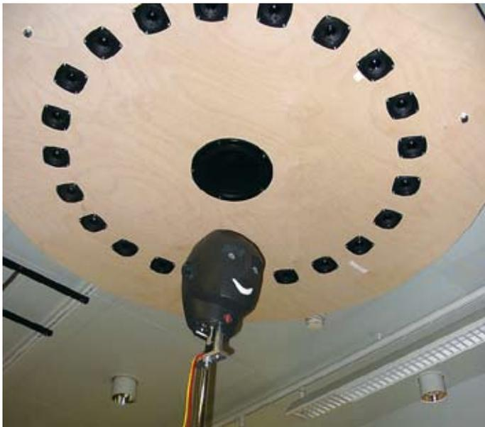
Abb. 4: »Virtueller Kopfhörer«: Ring von 22 Lautsprechern, mit deren Hilfe Schallquellen an die Ohren »projiziert« werden (vgl. Abb. 4) (nach Menzel et al., 2005)
