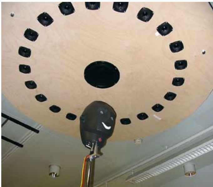
Abb. 4: »Virtueller Kopfhörer«: Ring von 22 Lautsprechern, mit deren Hilfe Schallquellen an die Ohren projiziert werden (nach Menzel et al., 2005)
