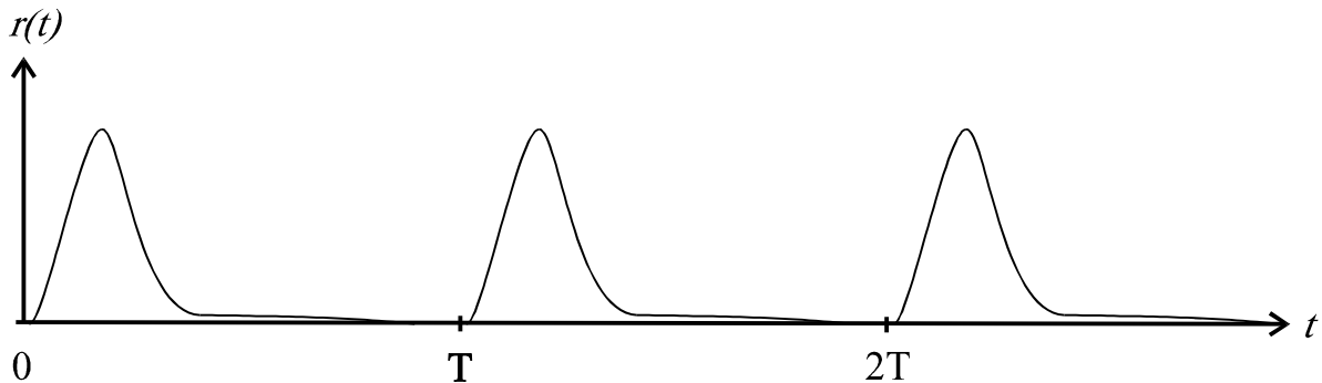
Bild 1.6: LZI-Pulsantwort (Ausgangssignal bei einem Puls p(t) am Eingang).
