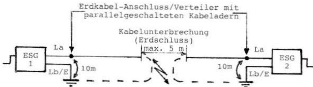
ESG-Einsatz bei zweiadrigem Anschluss (z.B. für Fernverbindungen)
