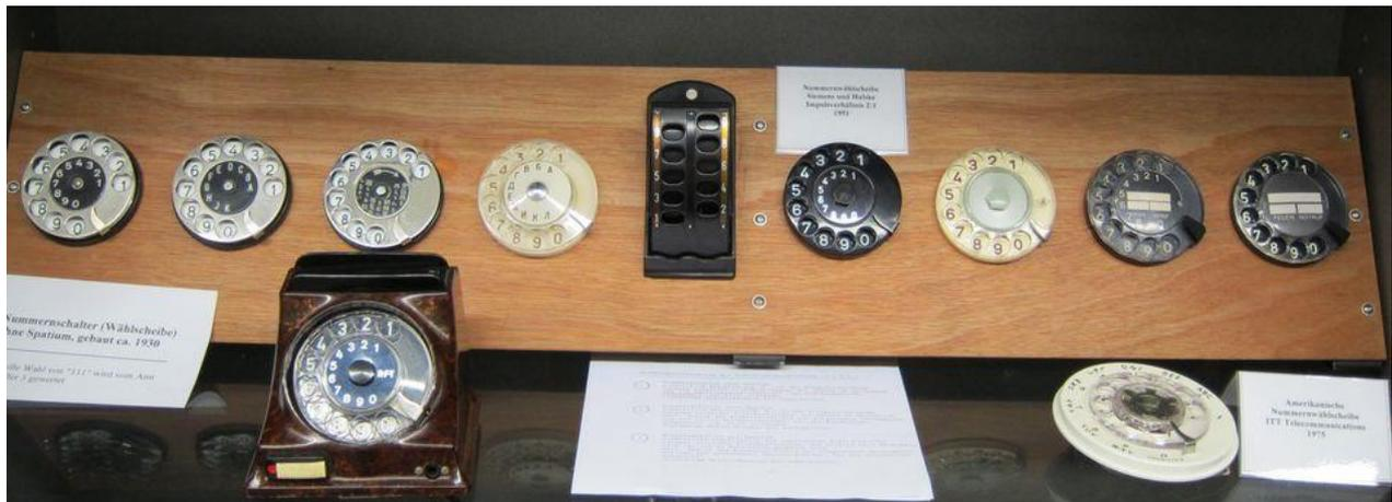
Zur Wahlinformationseingabe bei den direkt gesteuerten Vermittlungssystemen wurden fast vom Beginn der Selbstwähltechnik an die Nummernschalter (i.a. als Wählscheibe bezeichnet) eingesetzt. Sie waren an die dort verwendeten Schrittschaltwähler (Dreh-, Strowger-, Viereck-Wähler) optimal angepasst, Wahlimpuls-/Wahlimpulspausen-Verhältnis 1:1,6, 1 Wahlimpuls- und 1 Wahlimpulspause-Gesamtdauer 90 bis 110 ms (eingesetzt in Deutschland).
