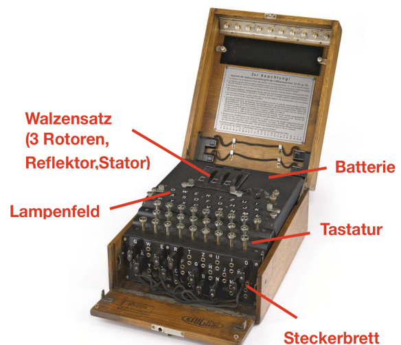
Figure 3: Die Aufbau von der Enigma I [5]
