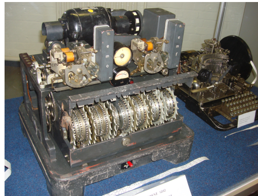
Figure 21: Lorenz-Schlüssel-Zusatz SZ 42 mit Fernschreiber [16]
