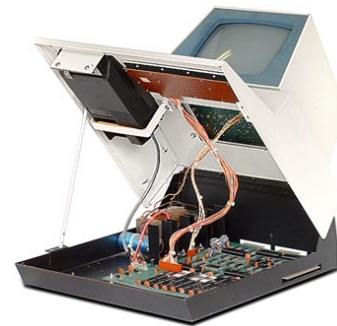
Abbildung 2: Geöffneter PET 2001 - Erkennbar ist die weiße Halterung unterhalb des schwarzen Kassettenspielers [14].
